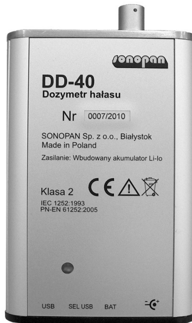
Rys. 1. Dozymetr hałasu DD-40 - widok ogólny.
