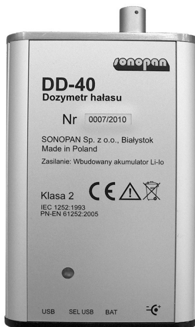
Rys. 1. Dozymetr hałasu DD-40 - widok ogólny.
